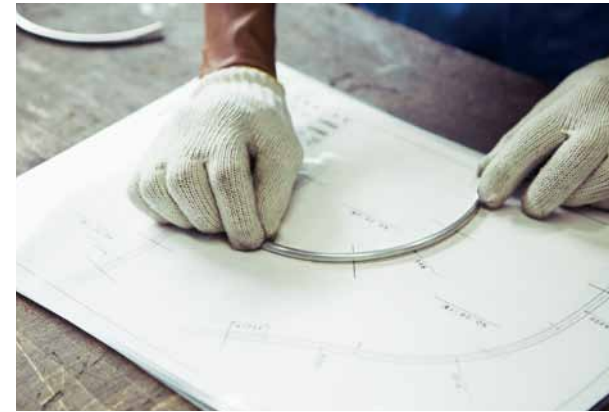
人の手で器具を動かすため微妙なRの調整も可能だが、現在は量産に対応するための体制も整えている。
